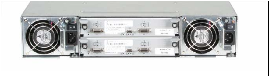
Bild 16: Zweites SAS I/O-Modul einbauen
